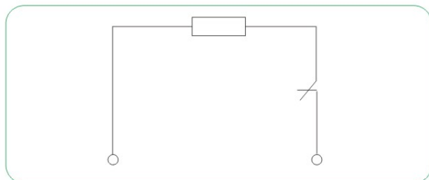
ZHMLE分励脱扣器接线图
